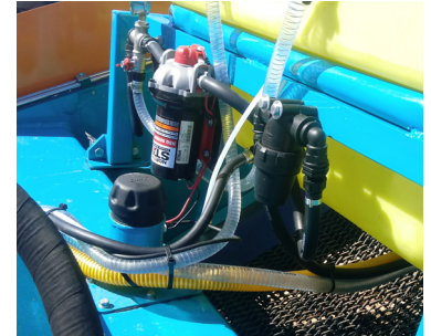
Moteur électrique de la pompe
